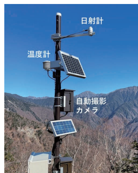
図2 気象観測と自動撮影カメラを一体化した観測事例。場所は長野県しらびそ高原(標高1918m)。カメラは南アルプスの上河内岳付近を撮影対象としている。
