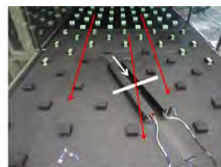
風洞内部に設置された建物模型 模型に対する風向を床面パネルの回転で変えられる。 観測する鉛直断面の位置と断面を見る方向を白で表示。 風洞内で発生させる風向を表示。
