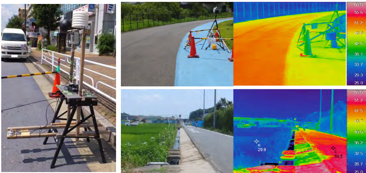
図3 放射熱環境観測（左：測定機器 右上：公園内の遮熱舗装が敷設された園路 右下：水田）
